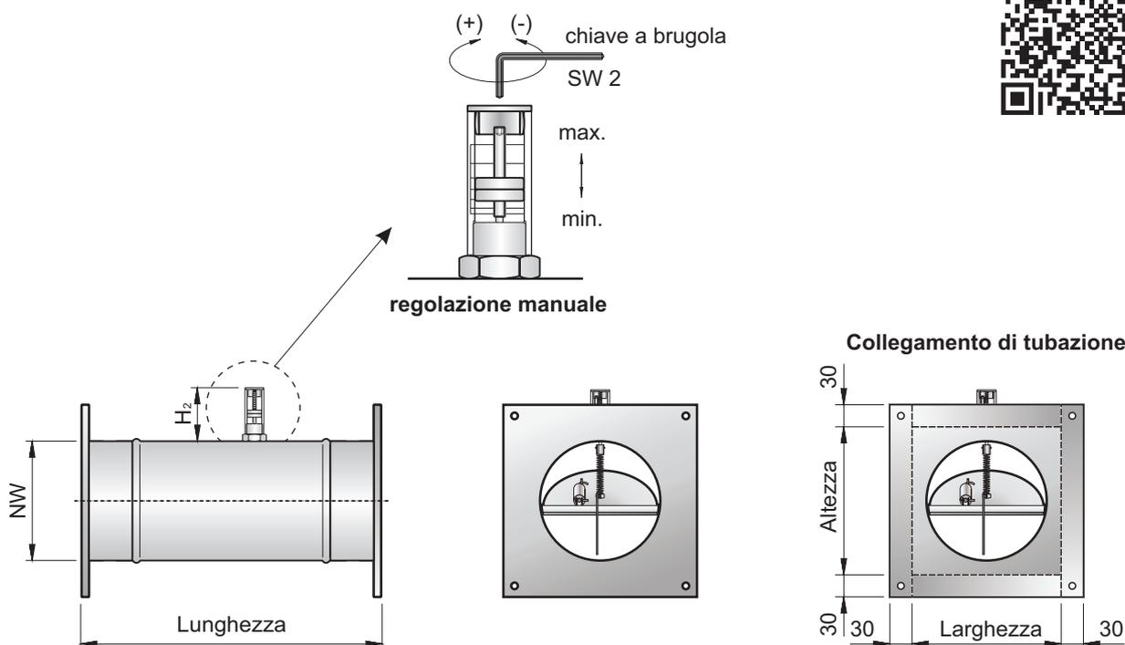
Il regolatore VRRK-N costituito da un regolatore di portata aria circolare a valore costante con i pannelli di collegamento a due lati in acciaio galvanizzato.
