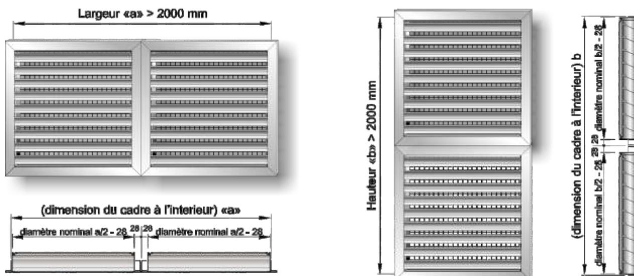
En cas d'installation sans cadre mural, prière de prévoir un châssis pour la connexion des deux registres.
