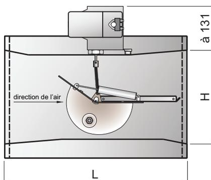
**No. de réf. 504:** Construction et principe de fonctionnement voir no. de réf. 503, mais avec interrupteur auxiliaire pour déclencher une commande à réglage supplémentaire.
