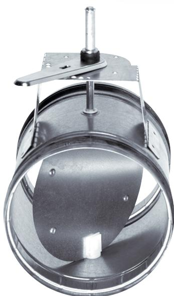
Le **registre simple combiné DKL n° 9227** est un développement amélioré de la méthode éprouvée du registre simple n° 9228 d'Aerotechnik E. Siegwart. Le registre simple combiné est fabriqué en usine avec un levier pour le réglage manuel et en même temps avec une console pour moteurs électriques (Belimo LM/CM). Une éclisse de montage pour le moteur est intégrée dans la console et peut être dépliée si nécessaire.
