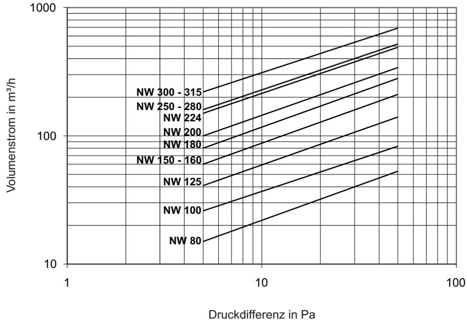
Diagramm1: Druckverlust des Wetterschutzgitters in der Zuluft
