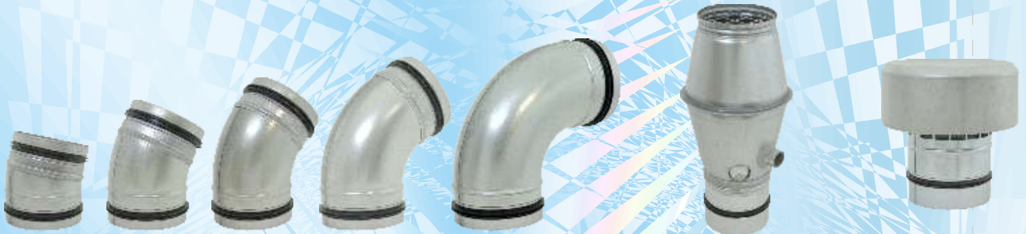
Halbschalenbögen 15° - 90°, luftdicht, laserstumpfgeschweißt ohne Überlappung auch in Edelstahl erhältlich
