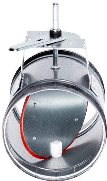
Die **Kombi-Absperrklappe AK Nr. 219** ist eine Weiterentwicklung der bewährten Absperrklappe Nr. 220 von Aerotechnik E. Siegwart. Die Kombi-Absperrklappe ist werkseitig mit einem Hebel zur Handverstellung und gleichzeitig mit einer Konsole für elektrische Motoren (Belimo LM / CM) ausgestattet. Eine in der Konsole integrierte Montagelasche für den Motor kann bei Bedarf ausgeklappt werden.
