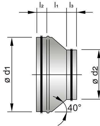
Bei Teilen mit Lippengummidichtung Lipstar sind L2 & L3 jeweils um ca. 3 mm kürzer.
