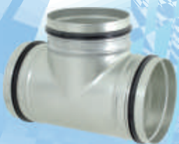
Abzweigstücke 90°, luftdicht laserstumpfgeschweißt ohne Überlappung
